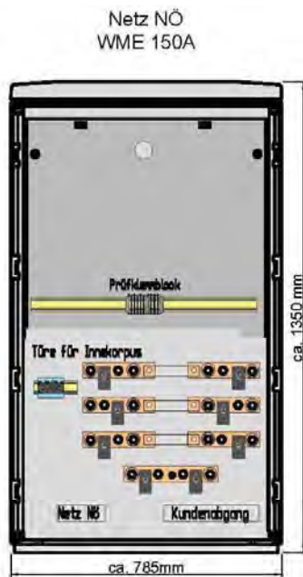
Abbildung 11: Schema typengeprüfter Zählerverteilerschränke für Wandlermesseinrichtungen (WME); für Freiluft- bzw. Innenraumaufstellung, Darstellung ohne Sockel
