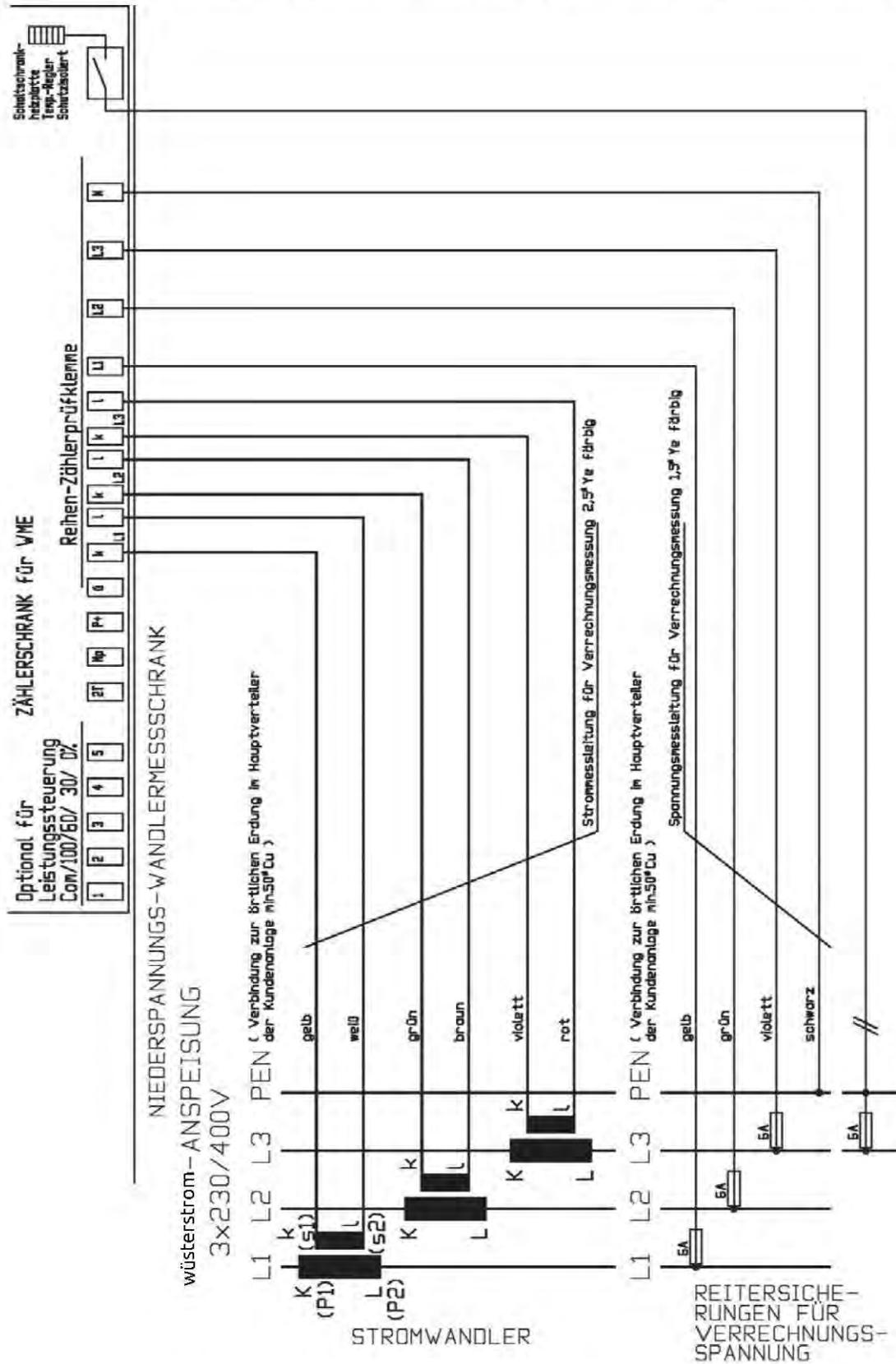
Abbildung 34: Wandlermesseinrichtung für Verrechnungszwecke – Einschubplattenverdrahtung für Zähler 3x230/400V, 5A mit optionaler Leistungssteuerung
