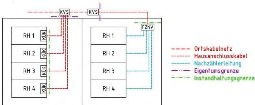
1. Jedes Haus wird über ein Netzanschluss-Kabel ab dem KVS (Zählerverteiler im RH) angeschlossen oder
