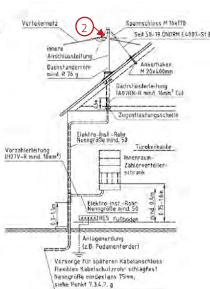
(Die Klemmen der inneren Anschlussleitung sitzen direkt am Verteilernetz; es entfällt der Anteil Hausanschluss)
